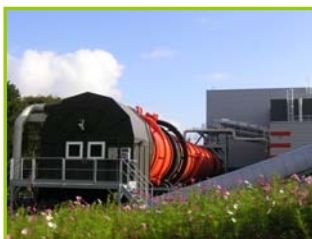
BRS de 42 m de long pour un diamètre de 2900 mm
