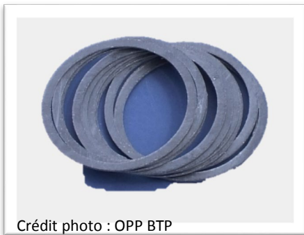
Joints amiantés de compteur à gaz
