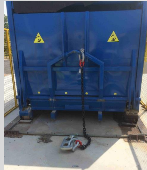
Arrimage des caissons
